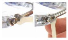
Lo stesso strumento è necessario per agire sulla porzione quadrata della vite di avanzamento interna alle cerniere che può essere attivata usando la chiave nella direzione indicata dalla freccia marcata laser: ogni quarto di giro di attivazione genera 0.1 mm di avanzamento.
