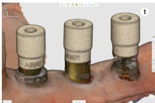
Fig. 1,2. Esempio di scansione intraorale effettuata con ScanBody IPD ProCam dotati di librerie con correzione delle aberrazioni dimensionali.
