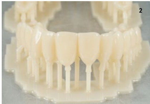
Fig. 2. Esempio di lavorazione in resina di strutture stampate in 3D. Immagine su gentile concessione di DentOne Laboratorio Odontotecnico.
