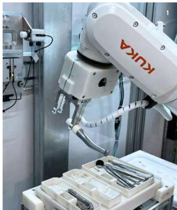
Fig. 1 Gestione dello strumentario attraverso un braccio robotico antropomorfo.
