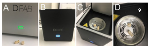
Fig. 9. Polimerizzazione dei restauri con DCURE® (DWS Srl, Thiene, Vicenza, Italia). (A) I restauri asciugati e pronti alla polimerizzazione; (B) il dispositivo di polimerizzazione DCURE® in azione; (C) i restauri inseriti per la polimerizzazione; (D) terminata la polimerizzazione, i restauri sono pronti per essere applicati clinicamente.
