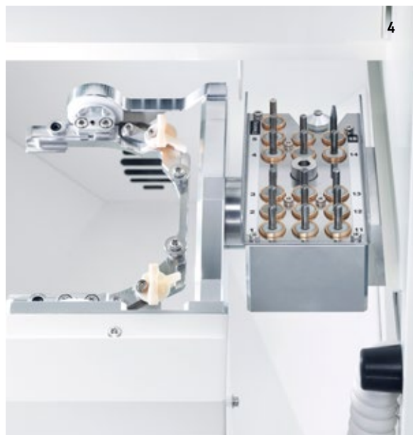
Fig. 4. DWX-52D di DGS SHAPE è equipaggiato con cambio utensile automatico fino a 15 frese, per la fresatura di diversi materiali.
