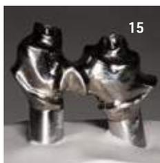
Fig. 15. Struttura in titanio validata su modello gesso
