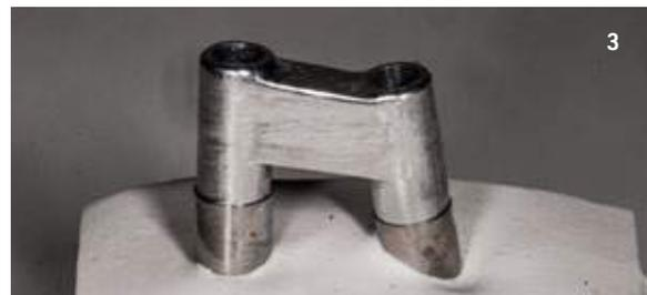
Fig. 3. Provino in alluminio fresato dal pieno su modello gesso
