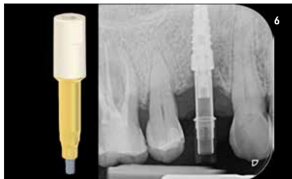
Fig. 6. RX endorale di controllo del corretto accoppiamento dello scan-abutment IPD.
