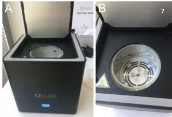
Fig. 7. Polimerizzazione dei restauri in forno DCURE®. (A) La polimerizzazione dura pochi minuti; (B) i restauri polimerizzati e pronti alla consegna
