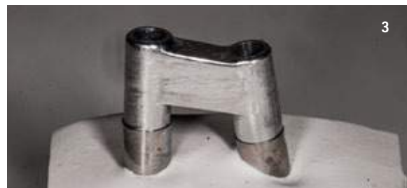
Fig. 3. Provino in alluminio fresato dal pieno su modello gesso
