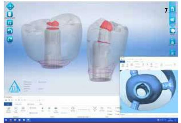
Fig. 7. Venivano predisposte specifiche strategie dedicate alla fresatura di zirconia monolitica su interface da incollaggio.
